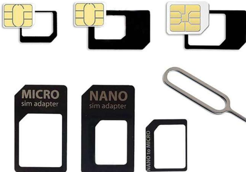
«Симку» (сим-карту) следует установить в специальное гнездо, отсек, выдвигающийся слот. В некоторых моделях он может открываться с помощью металлического ключика. Заостренный конец нужно будет вставить в отверстие на одной из сторон смартфона. Вот так алгоритм действий может быть изображен на инструкции к смартфону **1.4**.
